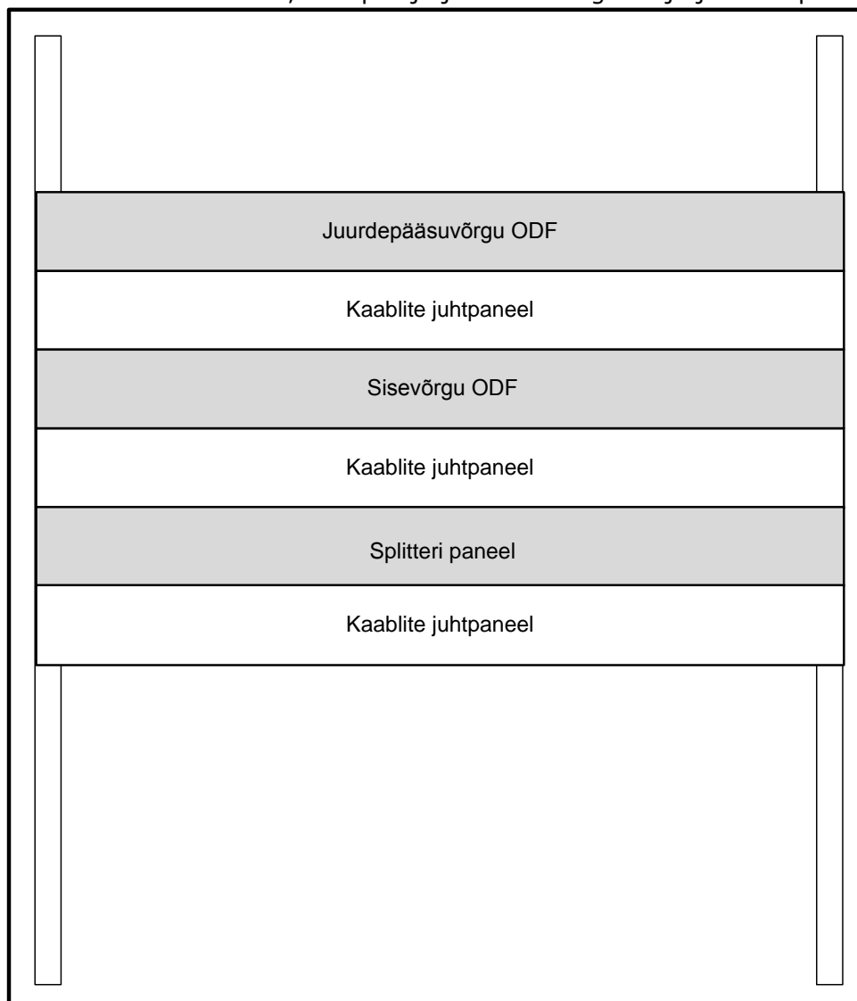
Joonis 1. 5-korruselise, 3 trepikoja ja 45 korteriga maja jaotuskapi sisu
